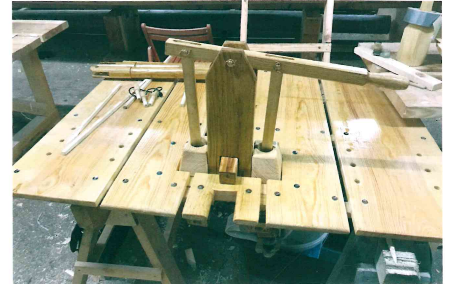
Abb. 11: Lenzpumpe nach dem Typ Dramont, mit einer Leistung von 16 l/min.
