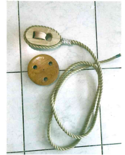
Abb. 8: Teile der Takelage: Juffern und Blöcke.
